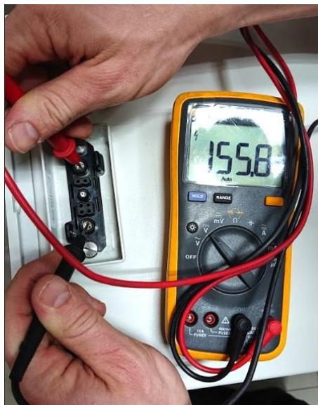
Wenn die gemessene Spannung deutlich vom Nennwert abweicht, überprüfen Sie die Spannung der einzelnen Module, wie in den folgenden Abschnitten gezeigt.
